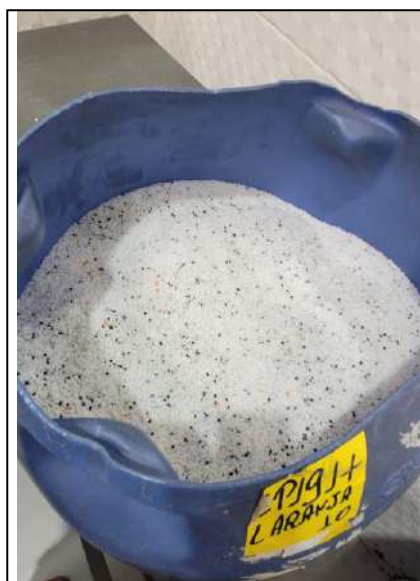
Figura 54 – mistura de polipropileno com corante
