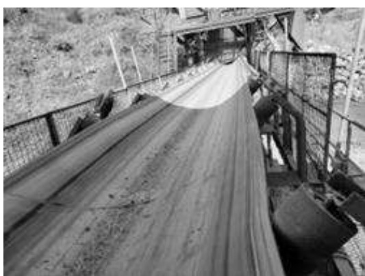
Figura 8 - Transportador de correia inclinado, dimensão 48" x 120m
