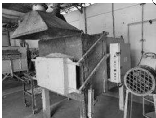
Figura 48 - Forno elétrico laboratório químico para copelação
