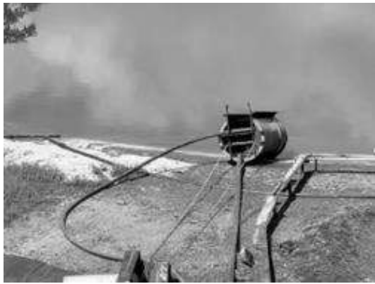
Figura 49 - Conjunto de 4 evaporadores MINETEK
