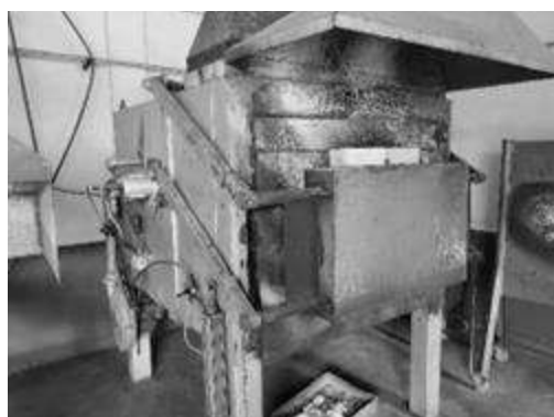
Figura 46 - Forno gás basculante para fundição DJ Fornos
