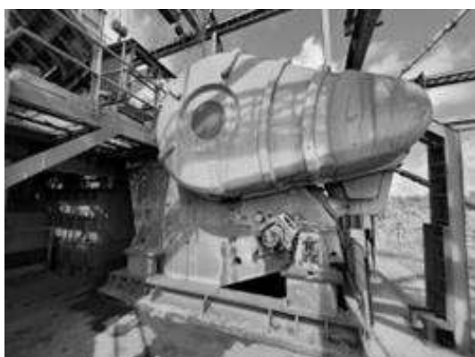
Figura 3 - Britador de mandíbulas METSO, modelo Nordberg C150, tamanho 55"x47", com capacidade de 880Mtp/h (acionamento de 300hp)
