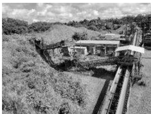
Figura 10 - Transportador de correia inclinado, dimensão 48" x 67m
