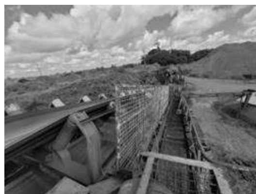
Figura 6 - Transportador de correia inclinado, dimensão 48" x 204,5m
